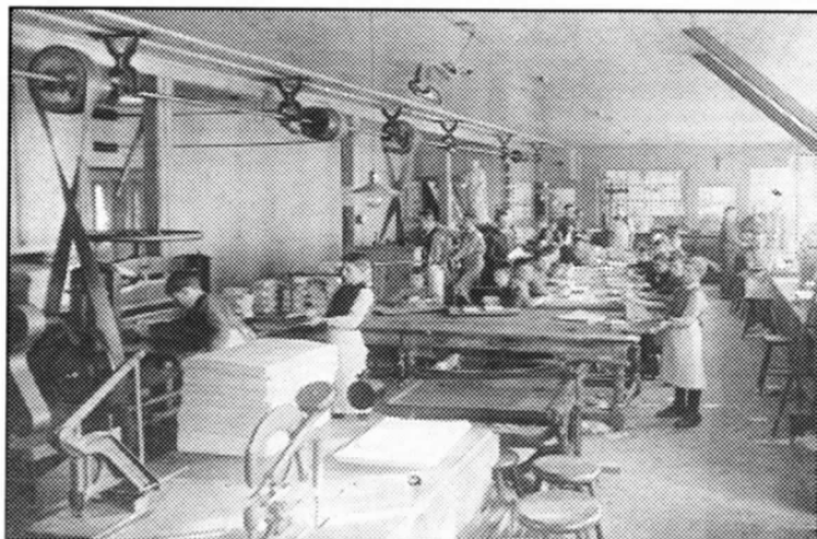
l'école d'imprimerie, à gauche, et celle de reliure, à droite. Électrifiées en 1889, les ateliers étaient alimentés par l'énergie électrique et on activait les machines à l'aide de moulinets fixés au plafond.
