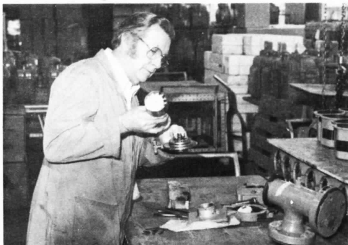
Lucien Longpré, à son travail à la Northwestern Utilities Ltd, d'Edmonton, alors qu'il s'affaire à la réparation d'un compteur de gaz naturel. Cette photo fut prise en 1956, mais rien n'a vraiment changé depuis.
